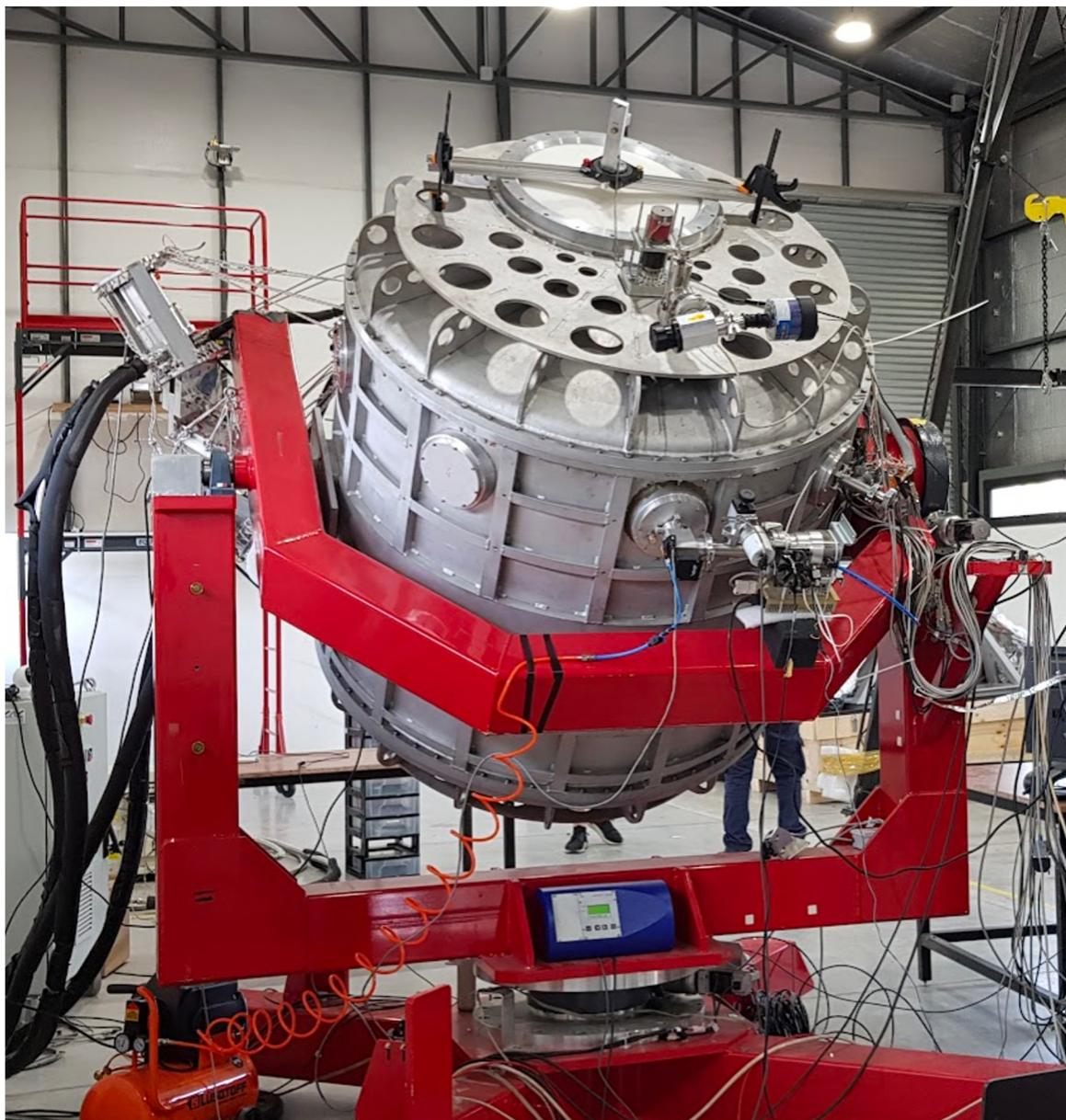
Il criostato che contiene lo strumento QUBIC durante i primi tests nel laboratorio di Salta. Il criostato è stato progettato e realizzato a Roma-Sapienza.
